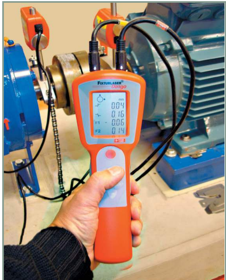
Med Fixturlaser Dirigo får man resultatet af opretningen efter kun 3 tryk.
